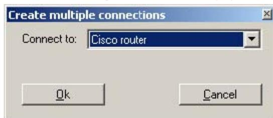
Wählen Sie den Knoten aus, zu dem mehrere Verbindungen hergestellt werden. Es wird eine neue Verbindung für alle ausgewählten Entitäten erstellt. Der ausgewählte Knoten ist der gemeinsame Endpunkt für jede einzelne Verbindung.
